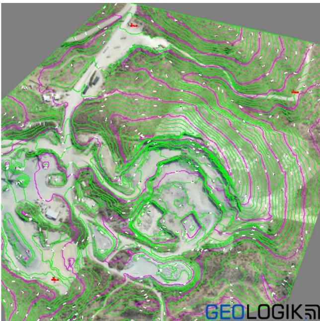
Nuestros relevamientos se realizan con equipamiento RTK (Real Time Kinematic), esto significa que se pueden obtener coordenadas precisas en tiempo real y en base a estas obtener Ortomosaicos y Modelos de Elevación digitales con una excelente resolución espacial.
